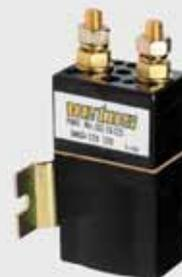
Usare il relè solo per avviare un motore elettrico (es. di un salpancora), con una potenza massima di 1,5 kW a 12 Volt o 3 kW a 24 Volt.
