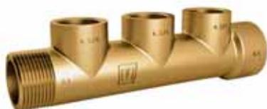
I collettori VETUS permettono di collegare più tubazioni ad un solo passaparatia. Sono realizzati in bronzo resistente all'acqua di mare (ISO CuZn35Al1). Possono essere collegati anche a un passaparatia con valvola a sfera per l'aspirazione dell'acqua. Si sconsiglia di connettere più motori o generatori a una sola linea di aspirazione acqua.
