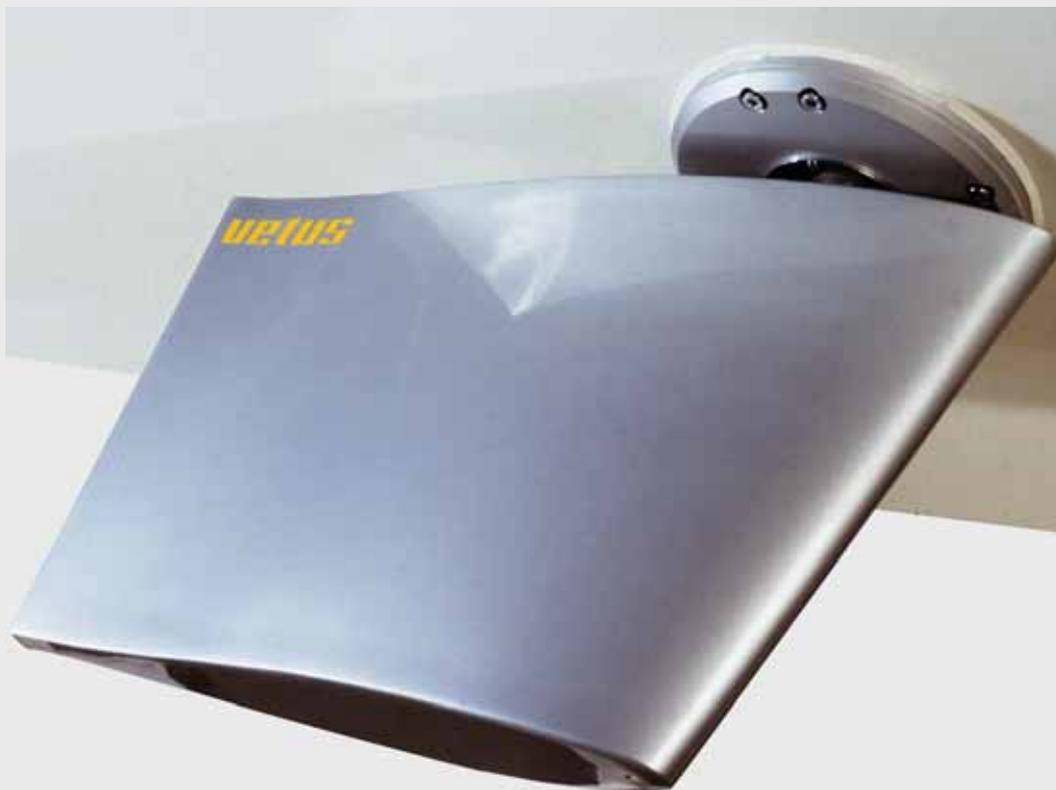
Gli stabilizzatori sono costituiti da una coppia di pinne, fissate sott'acqua a destra e a sinistra circa a metà della lunghezza della linea di galleggiamento. Queste pinne reagiscono automaticamente ai movimenti di rollio e di beccheggio della barca e li limitano a proporzioni minime. In un certo senso la loro funzione può essere paragonata a quella degli alettoni di un aeroplano che attenuano considerevolmente i movimenti improvvisi dell'aereo in situazioni negative.
