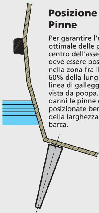
Per garantire l'efficienza ottimale delle pinne, il centro dell'asse delle pinne deve essere posizionato nella zona fra il 50 ed il 60% della lunghezza della linea di galleggiamento vista da poppa. Per evitare danni le pinne devono essere posizionate bene all'interno della larghezza del fondo barca.
