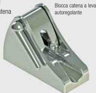
**Importante:** I salpancora Maxwell devono essere usati insieme a un blocca catena e/o in alternativa un dispositivo ammortizzatore per alleggerire il salpancora mentre è all'ancora. Il blocca catena e/o l'ammortizzatore deve anche essere usato per assicurare l'ancora nella posizione totalmente sollevata mentre si è in movimento.
